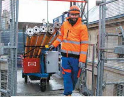
Kross Chantier, remorque intelligente et électrique développée par Bouygues Construction en partenariat avec la start-up K-Ryole pour diminuer la pénibilité des compagnons sur les chantiers
